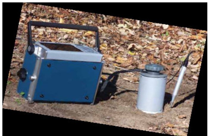
CIRAS-2 と一緒に使われる SRC-1 土壌呼吸チャンバと STP-1 土壌温度プローブ。
