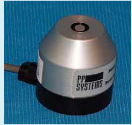
PAR センサ PAR ( \mu\text{mol m}^{-2}\text{s}^{-1} ) 測定用
